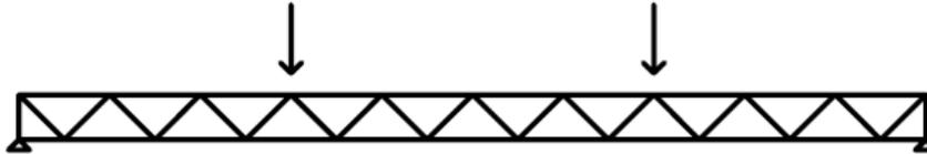
LF 3: Einzellast in den Drittelpunkten, symmetrisch angeordnet in den Knoten der Unter- oder Obergurte.
